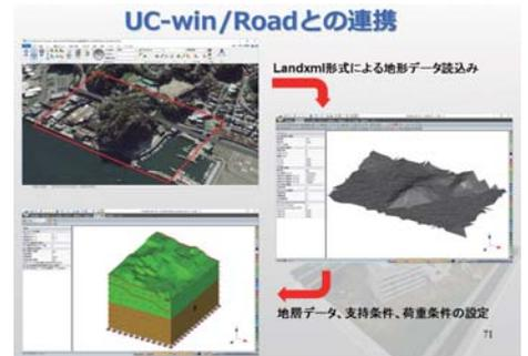
▲ UC-win/Road で作った地形の 3D モデルを GeoFEASFlow 3D に読み込むと、入力データの作成がスピーディーに行える
