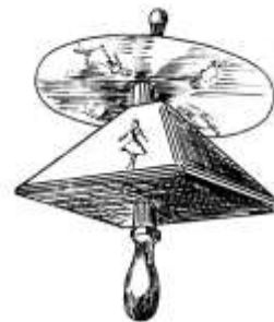
図 2 角錐形のポリゴンミラーを用いる プラクシノスコープ(19 世紀中ごろ)
